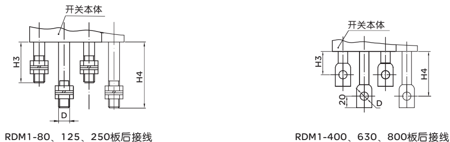
图8 RDM1系列板后接线外形及安装尺寸
